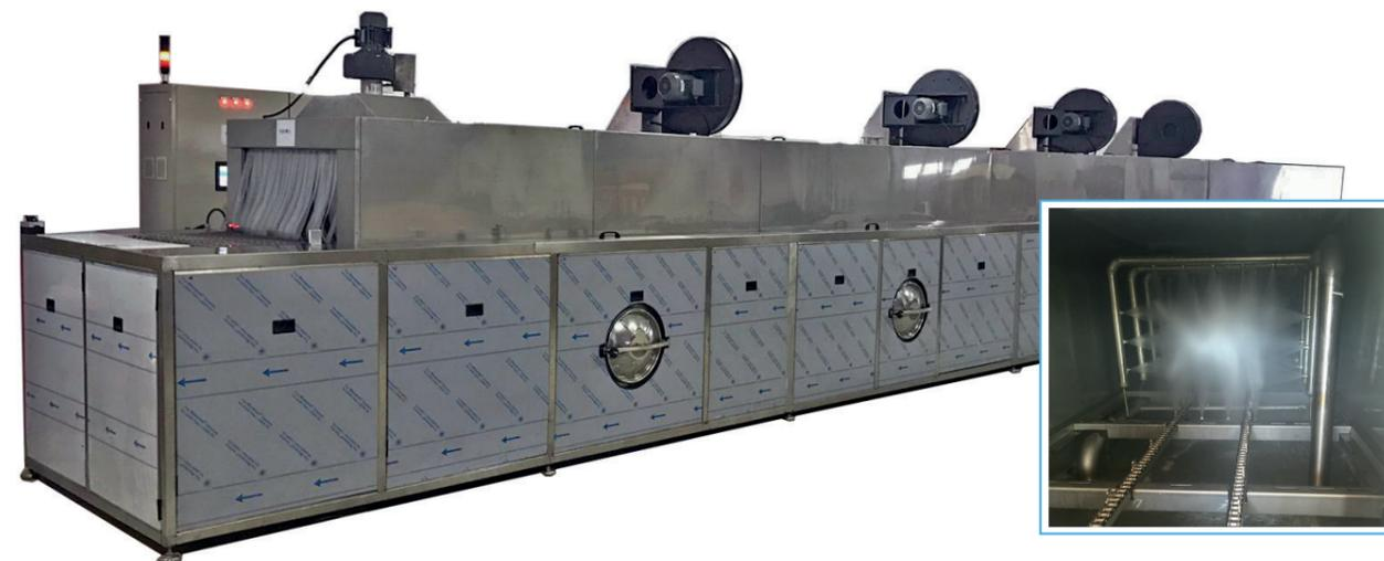
Как правило, предпочтительны клиентами, осуществляющими серийное производство или имеющими большие производственные объемы. Очищаемые продукты, перемещаясь вдоль линии, проходят различные процессы. В зависимости от потребностей клиентов размеры машины, скорость конвейера, процессы и их очередь может меняться.
